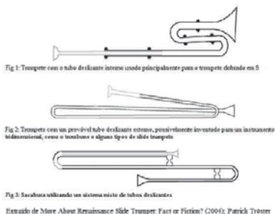
Fig 1: Trompete com o tubo deslizante interno usado principalmente para o trompete dobrado em S
